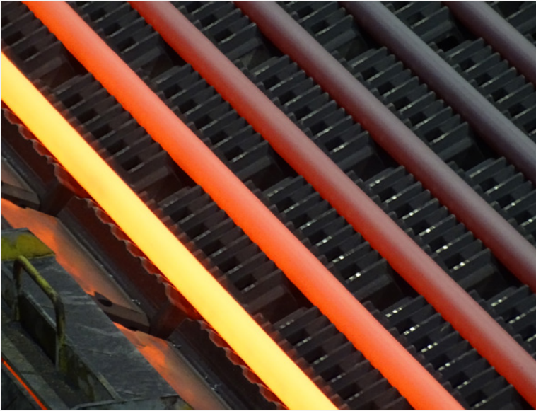
Bild 4: Kontrollierte und gleichmäßige Abkühlung im Kühlbett
